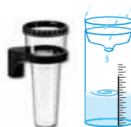
Дождемер (показывает количество осадков)
